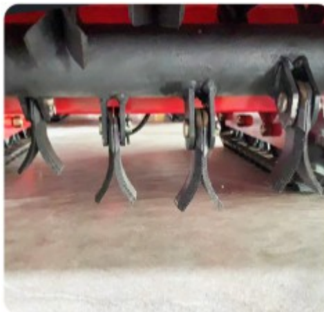
Sečiva od legure manganskog čelika, dvostruko oštrog sečenja
