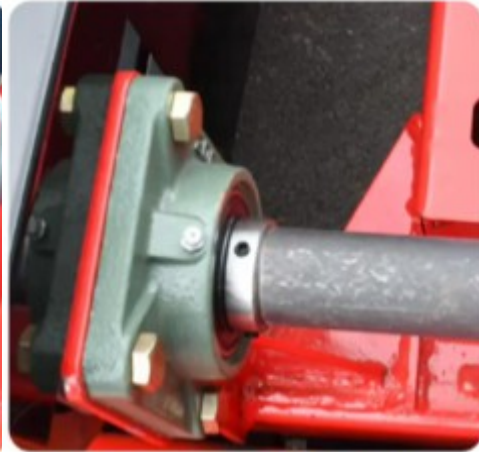
Ležajne jedinice za velike brzine, povišene temperaure i za duži vek trajanja
